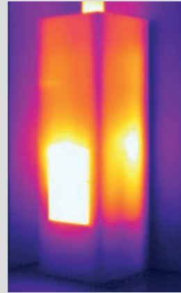
3 uur na verwarming Gemiddelde oppervlaktemperatuur 88 °C
